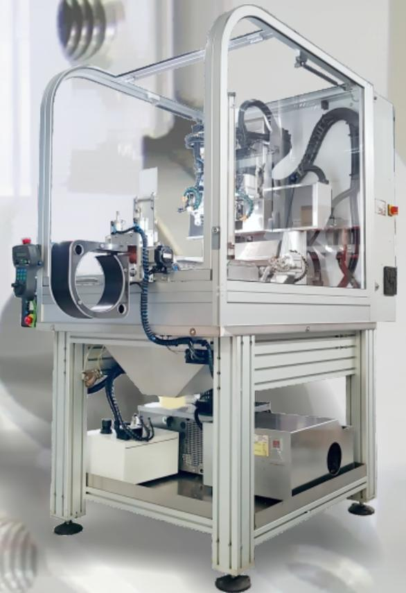
F1 è la soluzione ideale altamente produttiva per satinatura, incisione, diamantatura e taglio finale di ciondoli e di altre parti di oggetti complessi. Disponibile con dispositivo di trascinamento automatico e funzione di allineamento automatico per una lavorazione precisa su entrambi i lati di bobine e singoli fogli di materiale.
