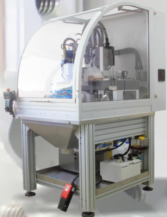
La F35 è la fresatrice a 5 assi più versatile ed evoluta nella classe delle macchine a CN compatte per tutte le lavorazioni di incisione, diamantatura, foratura e pre-incassatura su oggetti di diversi materiali e spessori come palline, anelli e bracciali, anche vuoti, tondi, ovali e di forma irregolare, sia raggiati che piatti.
